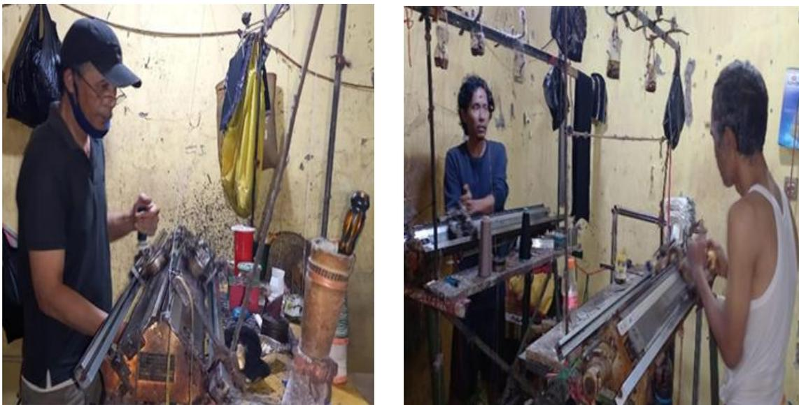
**Gambar 1. Proses Merajut Menggunakan Mesin Manual**
