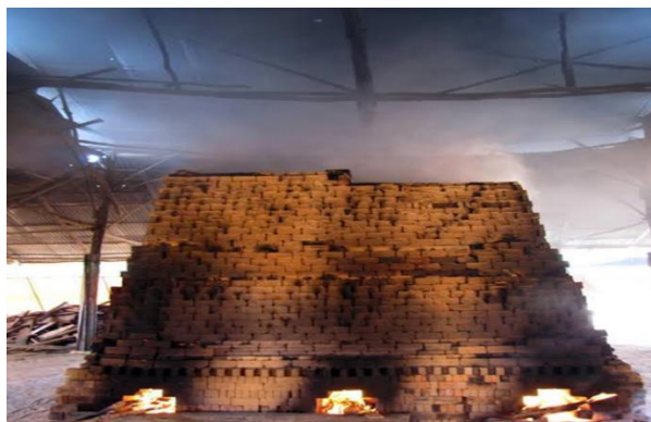
Gambar4. Gambar Proses Pembakaran Batu Bata Yang Mimbulkan Kebulan Asap
